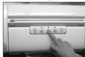
Presione SELLO, cuando termine, pulse ambos botones y desbloquear la tapa abierta
